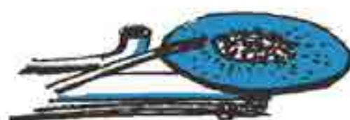
Plato de combustión Auto limpieza por la alimentación de los pellets
